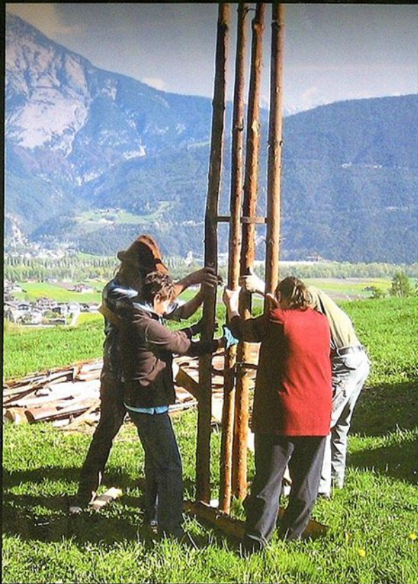
Schritt 1: Der Quandelschacht wird aufgestellt und der Rost verlegt.
