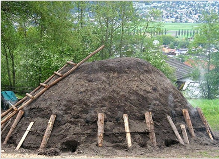
Gut zu erkennen ist der leichte Rauch, der aus den Zuglöchern strömt
