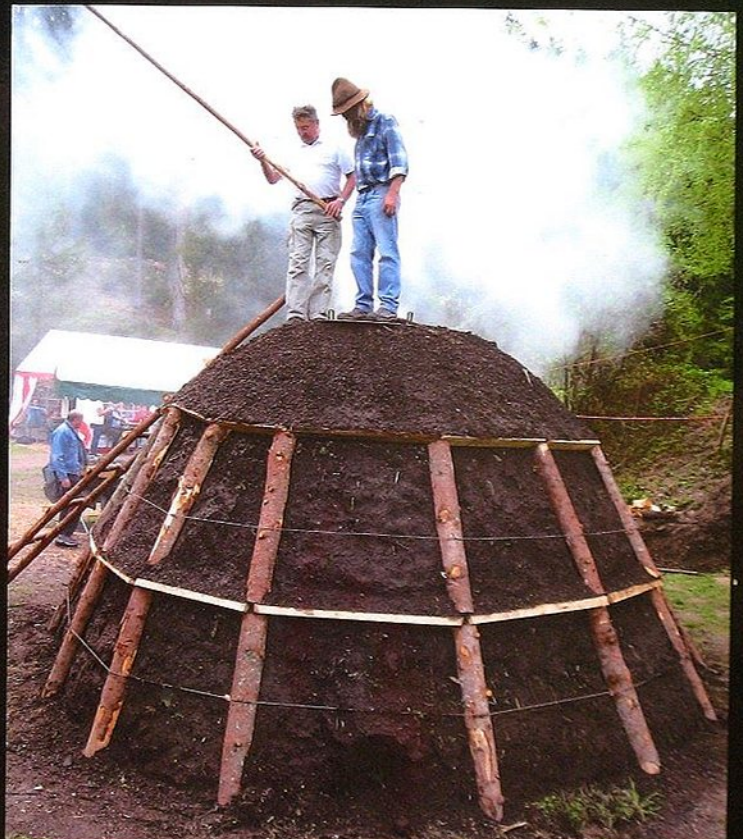
Schritt 5: Der Meiler wird in Glut gesetzt. Der Quandelschacht wird mit Glut von außen befüllt. Dann wird mit Holz aufgefüllt, neben dem Deckel werden später Rauchöffnungen gestochen und der Deckel wird geschlossen.
