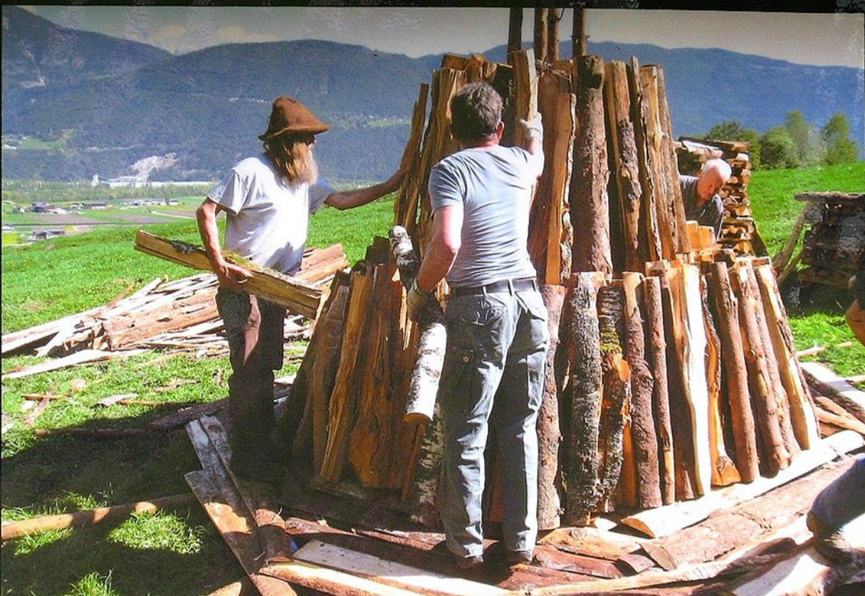
Schritt 2: Das Holz wird möglichst ohne Hohlräume zweilagig geschichtet (unten die Fußscheite, oben die Schneidel).
