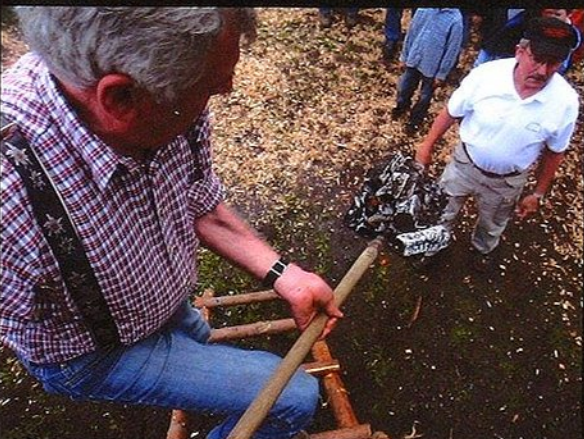
Schritt 5: Der Meiler wird in Glut gesetzt. Der Quandelschacht wird mit Glut von außen befüllt. Dann wird mit Holz aufgefüllt, neben dem Deckel werden später Rauchöffnungen gestochen und der Deckel wird geschlossen.
